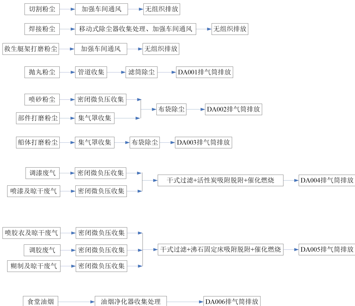
图 4.2-1 废气处理工艺流程图
